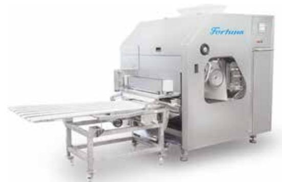
Bei der Konstruktion der Kopfmachine hat Fortuna besonderes Augenmerk auf ein umfassendes Hygienekonzept gelegt. Um die Verschmutzung der Antriebselemente mit Mehl zu verhindern, sind Antriebs- und Teigbereich strikt voneinander getrennt.
