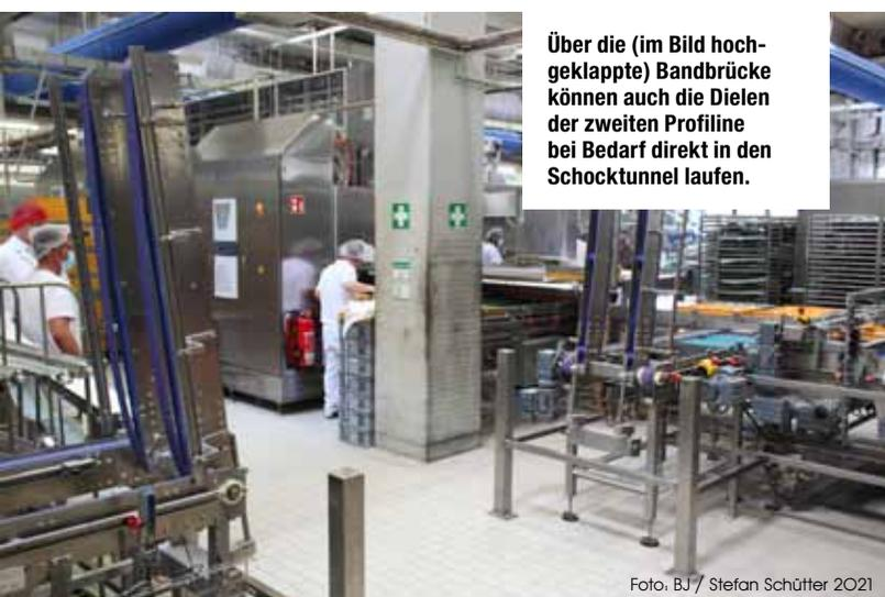
Über die (im Bild hochgeklappte) Bandbrücke können auch die Dielen der zweiten Profiline bei Bedarf direkt in den Schocktunnel laufen.
